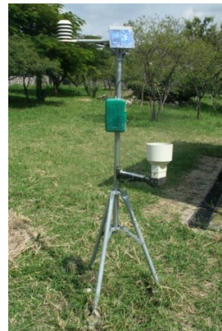
Figura 8. Estación con datalogger
