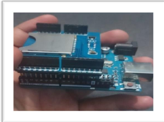
Imagen 5. Montaje SD Shield sobre ARDUINO UNO.
