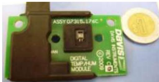
Figura 1. Termohigrómetro instalado en su tarjeta electrónica
