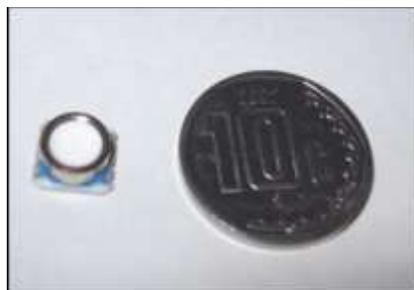
Figura 6. Barómetro electrónico
