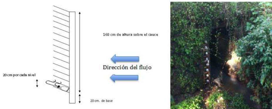
Figura 2. Torre utilizada para la toma progresiva de datos en un aumento de nivel. Modificado de FAO, 1997, a) presenta el diseño inicial y b) muestra la torre instalada en un punto de recolección de datos (Pacho Viejo, Coa.).
