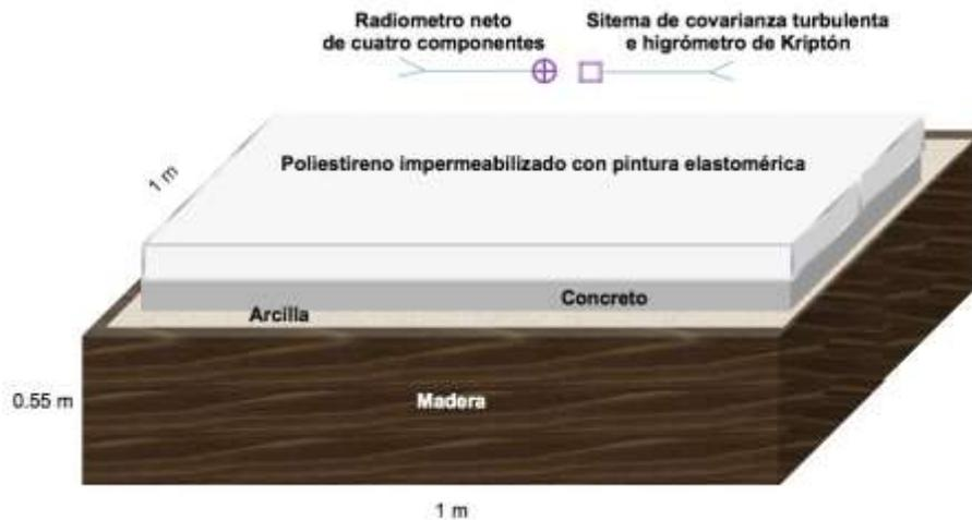
**Figura 1. Esquema del arreglo experimental losa de concreto poliestireno impermeabilizado.**
