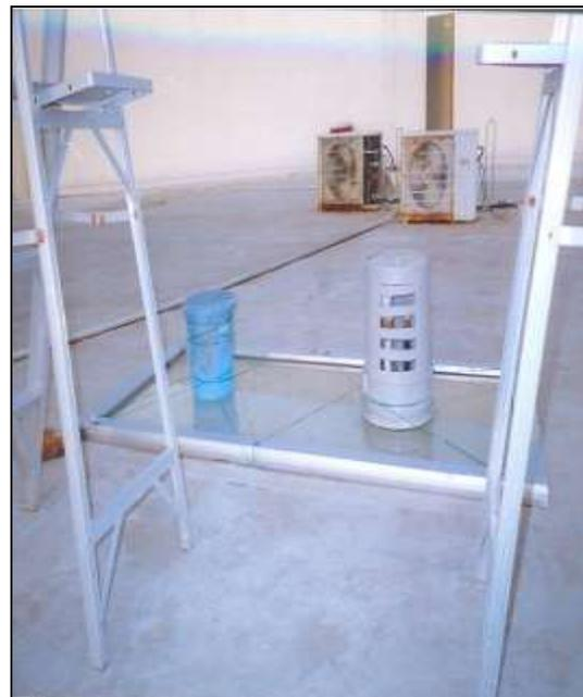
Imagen 3. Colector de partículas y de sulfatos construido en el Instituto de Ingeniería.
