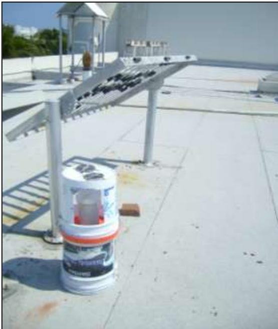
Imagen 2. Colector de sulfatos en la atmósfera construido en el Instituto de Ingeniería.
